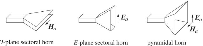
Fig. 21.2.1  $H$ -plane,  $E$ -plane, and pyramidal horns.
