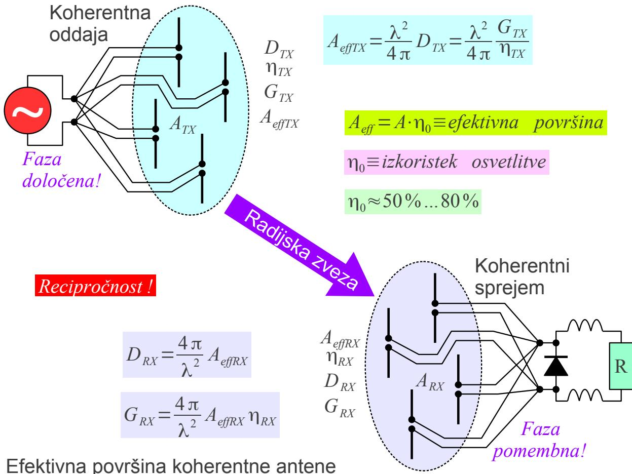
Z večanjem smernosti oddajne antene in sprejemne antene se povečuje moč sprejetega signala  $P_{RX}$ . Pogosto se pri tem raven topotnega šuma in motenj bistveno ne spreminja, saj so motilci več ali manj enakomerno razporejeni po smereh prihoda signalov. V nekaterih primerih se z usmerjenim sprejemom celo izognemo določenim motilcem oziroma znižamo raven topotnega šuma.
