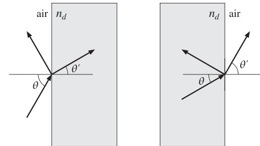
Fig. 7.4.1 Air-dielectric interfaces.
