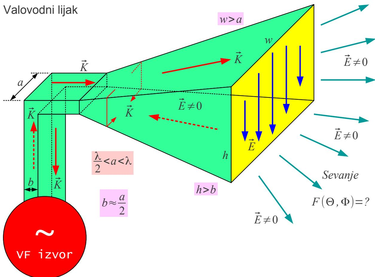
V piramidnem kovinskem lijaku seva ploskovni električni tok v stenah
