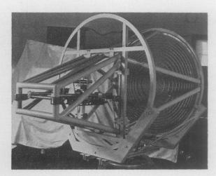
Fig. 5-Waveguide lens antenna.
