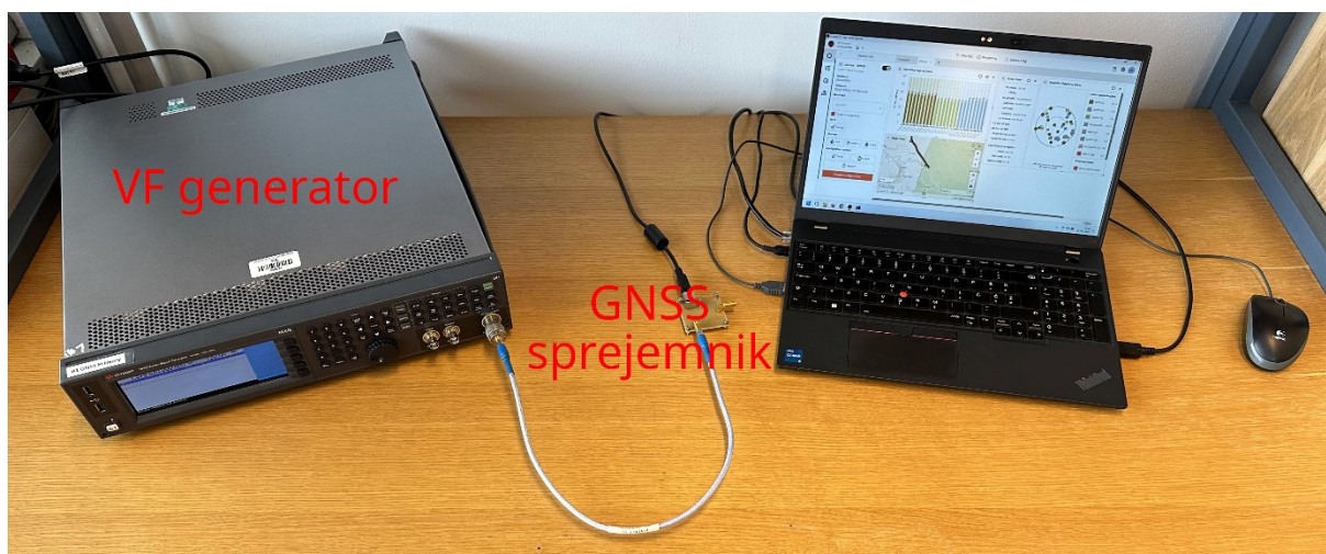
Slika 2: Slika vezave merilnih pripomočkov
