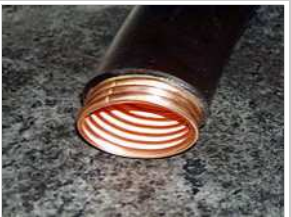
Elliptischer Hohlleiter für 3,8 bis 5,8 GHz
