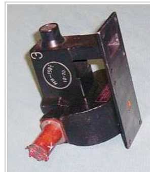
Magnetron mit Hohlleiteranschluss aus einem Radargerät
