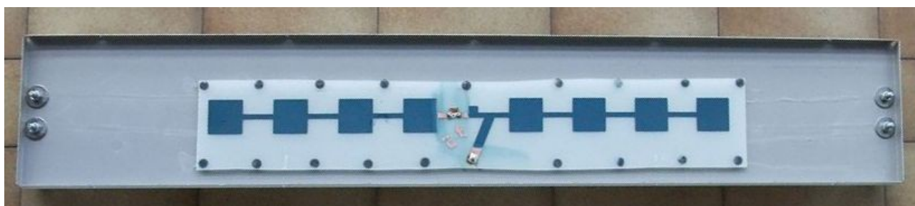
Slika 16 – Sektorska antena 8 krpic za 3400MHz.
