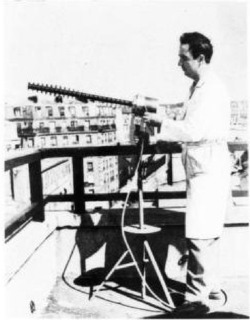
Fig. 14. — Antenne cigare à deux éléments \frac{L}{\lambda} = 4 fonctionnant de 1700 à 2000 Mc/s.
