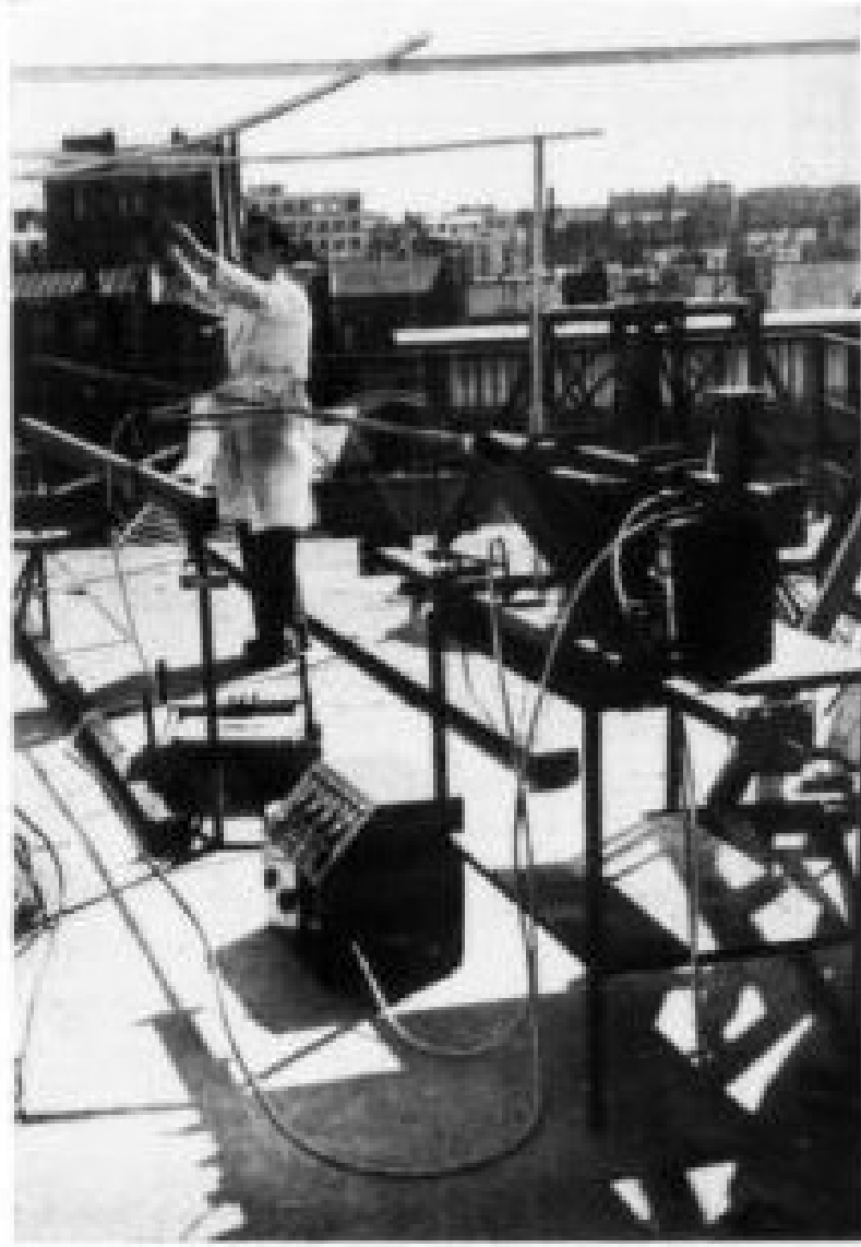
Fig. 8. — Mesure de phase le long d'une antenne de 80i en diélectrique artificiel.
