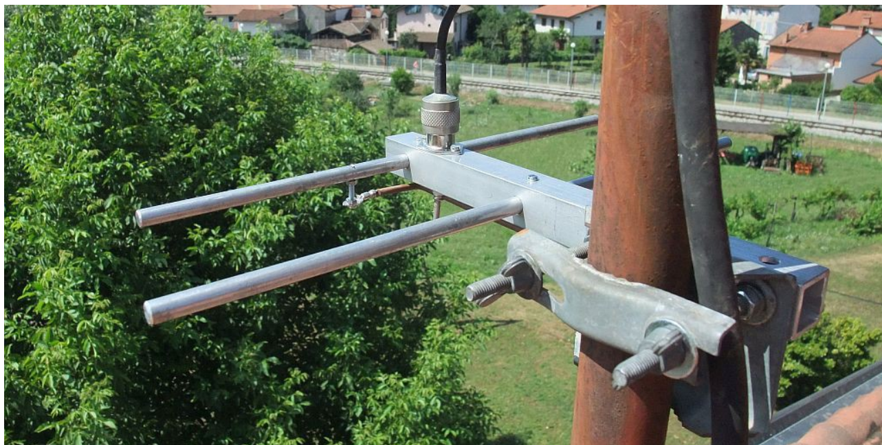
Slika 13 – HB9CV za 435MHz.
