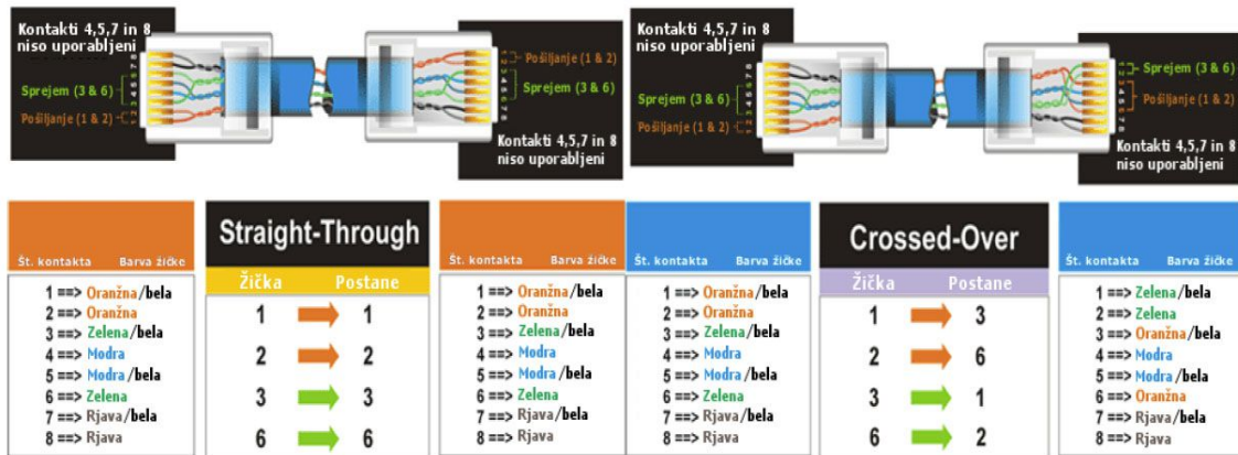
Slika 2: Povezave paric za naravnost (»straight«, leva stran) in navskrižno (»crossed«, desna stran) povezana tipa kabla.
