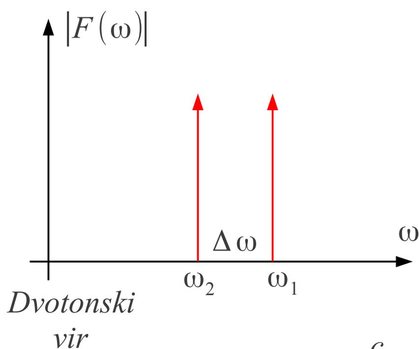
$$d_{\text{vzdolžna}} = \frac{c_0}{\Delta f} \equiv \text{vzdolžna koherenčna dolžina [m]}$$
