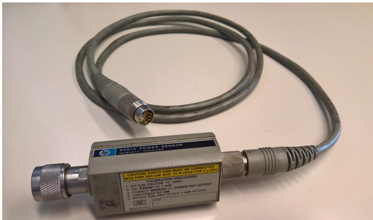
Slika 1: Merilna glava s termočlenom
